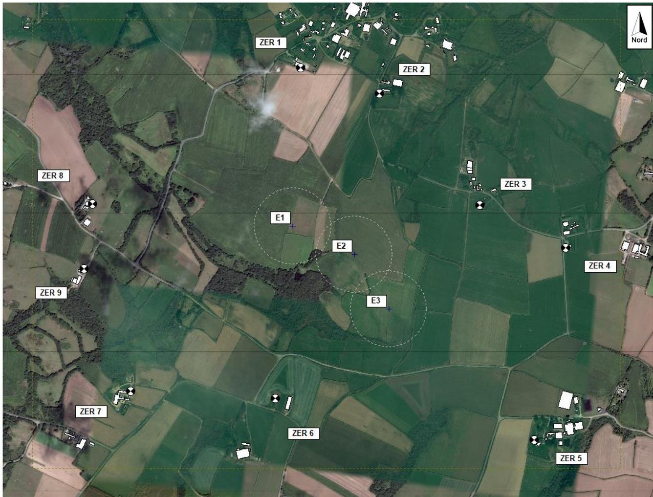
Le nombre et la localisation des récepteurs permettent de présenter une évaluation de l'impact acoustique dans les zones à émergence règlementée susceptibles d'être impactées par le projet. Les récepteurs sont placés en champ libre vis-à-vis du projet.
